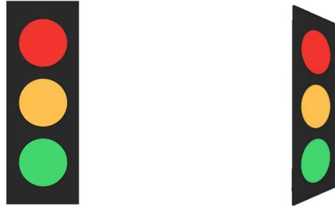
FIGURE 4 – Feu tricolore en situation idéale (fronto-parallèle), et avec inclinaison et/ou distorsion. Ce deuxième cas présente des cercles fortement distordus donc inexploitable par la transformée de Hough
